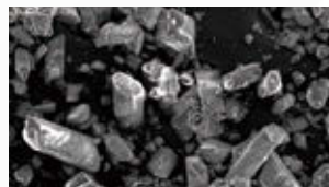
従来のパウダー(重炭酸ナトリウム) 平均粒子径73µm SEM画像(×150)
