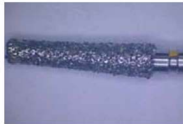
ダイヤ部が軸部に対して大きく曲がっている
