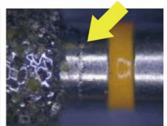
先端部に力が加わった為に生じた傷
