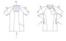
脇下カット部、脇ポケット部にメッシュ地を使用。作業中の動作により、衣服内で空気が循環、メッシュ部分の通気口から熱と湿気が押し出されます。
