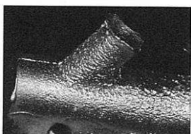
□基底部、スプルー、パターンの位置を正確に測定し鋳造欠陥部分をランナーバー部分に与え
