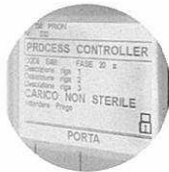
液晶表示は、プログラム/滅菌工程/日付/時間をリアルタイムに表示します。
