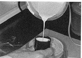
□埋没材の填入は、筆を用いて慎重に行います。
