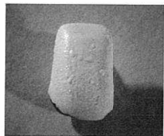
□オーバー焼成時点での気泡欠陥
