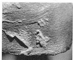
□合金表面処理不足による気泡欠陥部分の拡大写真
