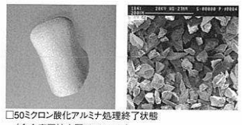
□50ミクロン酸化アルミナ処理終了状態 (合金表面拡大図×184mag)
