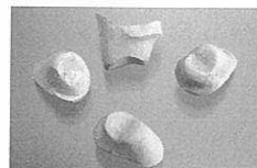
□酸化熱処理後の部分変色欠陥
