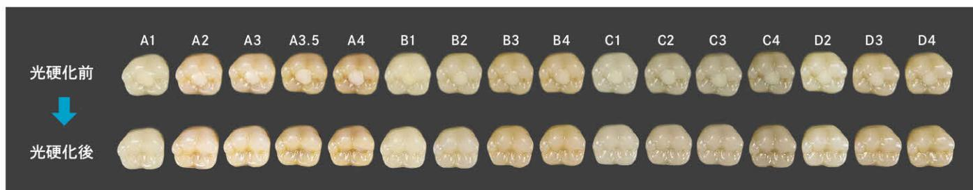
人工歯（白歯）I級窩洞（φ4mm×深さ2mm）を形成後、全ての窩洞にオムニクロマを充填。硬化前と硬化後の比較
