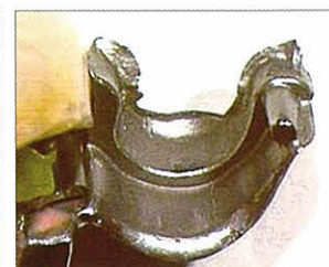
ブレーシングアームの内面
