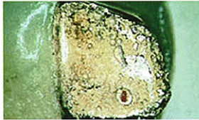
図10 破折したろう着面 表面の一部しかろうが流れていない
