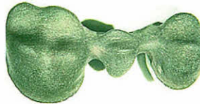
図1 酸化熱処理後フレーム表面の汚染状態が色むらによって確認できる
