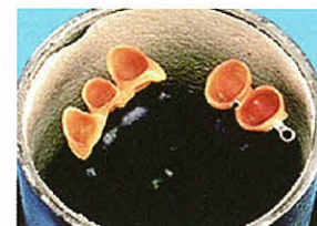
図6 (正) 正しい位置にワックスパターンが位置している
