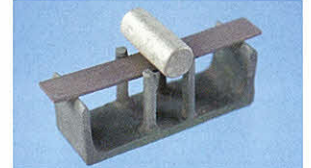
次に5gのプレシャスメタルで荷重をかけて焼成する。焼成温度は900°Cと930°Cの2回。
