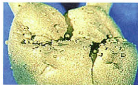
図10 鑄造体表面に気泡がある埋没材練和時に真空攪拌が完全でない
