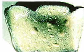
図2 オペーク焼成後の気泡: 酸化熱処理後にメーカーの支持通りのピックリング処理を行わなかったことが原因
