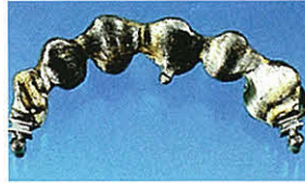
図11 フッ化水素によってポーセレンを除去したところ、 表面に大きなソルダーの残留物が見られる
