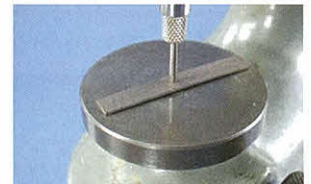
焼成後にそれぞれの合金の変形量を測定する。
