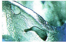
図1 ワックスアップの厚み不足によって、湯まわりが悪くなって鑄造欠陥が発生
