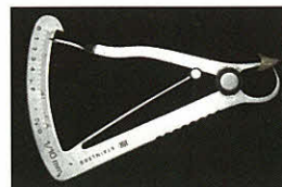
コーピングと陶材の合計厚みはわずか0.7mm
