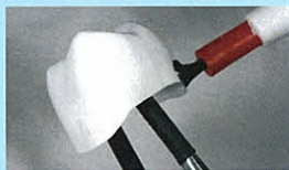
専用着色液 (ZENOSTAR Color Zr) をナイロンブラシで塗布します。
