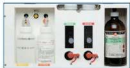
ホルマリン液自動注入装置
