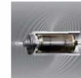
ボルバー i7に内蔵されている“コアレスモーター”はコア(鉄心)が無いため、回転体の重量が小さくなり、回転の制御性が非常に良く回転ムラが起りにくく、パワー効率も高く、全回転域で負荷が掛かっても一定したスピードを維持できます。
