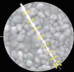
粒子の組成と形状の違いにより各層の透光性と物性をコントロール
