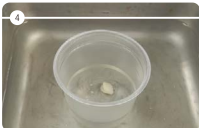
4 超音波洗浄(アルコール又はアセトン) またはスチームクリーナー洗浄
