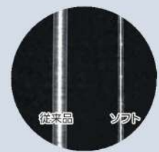
ブラシ毛の拡大写真 (約400倍)
