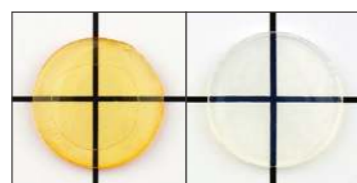
比較用試作品 ペレット（硬化直後）厚み：1.0mm
