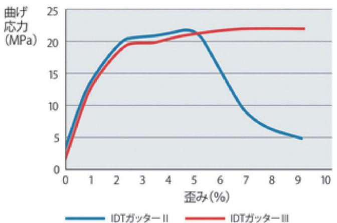
従来品は5%の歪みで亀裂が生じたが、IDTガッターIIIは10%歪んでも亀裂が生じず、折れにくさが向上したため、より差し込みやすくなりました。
