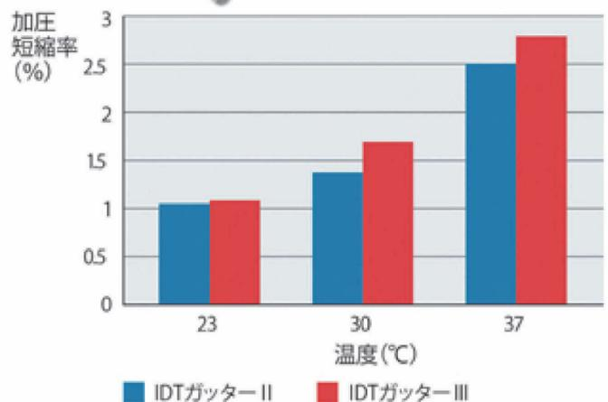
従来品よりも温度に応じた加圧短縮率が向上しており、常温付近では適度なコシを有し、体温に近い温度帯では根管内の側方加圧がしやすくなっております。
