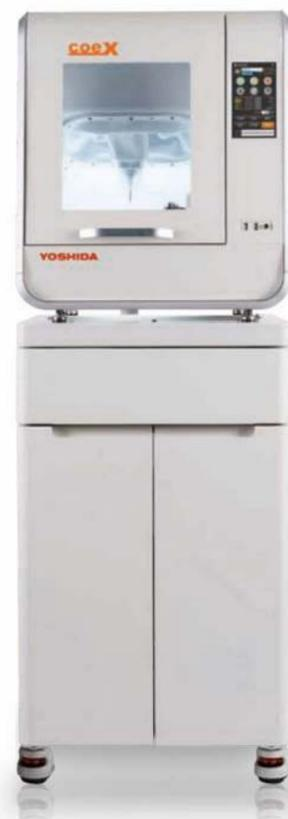
湿式・乾式両用。5軸機構を搭載し
