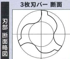
刃の方向が3分割され、バーが横ブレを起こしにくい。
