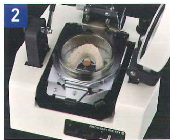
2 製作した模型に分離材を塗布し、シート・模型をセット
