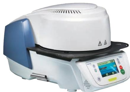
標準プログラムを絞り、シンプル操作を追求したファーンレスです。他のファーンレス同様、二段階焼成機能を備え、IPS e.max キャドのクリスタライゼーションやキャラクタライゼーションができます。20種類のフリープログラムを登録できます。
