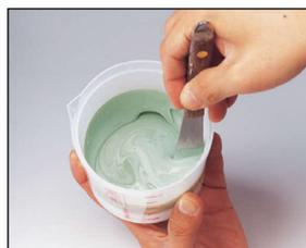
任意の容器にデュプリコンをA液→B液の順に(A:Bを1:1の割合で)計量します。計量方法は、容積比(mL)、または質量比(g)のいずれかで行います。一床当たりのおおよその使用量は、
