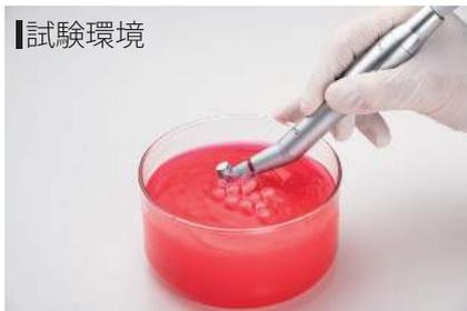
5倍速コントラアングルのヘッドを染色した水に浸けた状態で、20万回転で約10秒間回転させたあと停止させる。これを計5回繰り返し行う。
