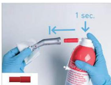
ノズルをコントラアングル後部より差し込み1~2秒間スプレー洗浄します。
