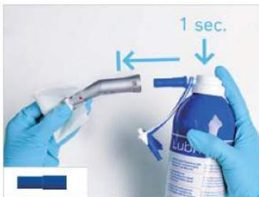
ノズルをコントラアングル後部より差し込み1~2秒間スプレー注油します。
