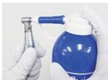
コントラアングルのチャック部よりスプレーノズルを差し込み1~2秒間スプレー注油します。
