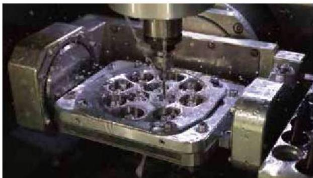
工業界で実績のある最大30,000回転の高トルクスピンドル(瞬時最大18cN・m、連続使用最大9cN・m)※を採用し、チタンを中心とした歯科材料を十分で安定した回転数で加工できるようにしました。チタン加工時のミリングバーへの負荷を最大限に抑え効率よく加工できます。さらに、高性能なサーボモーターを採用し、精密な加工が可能です。
