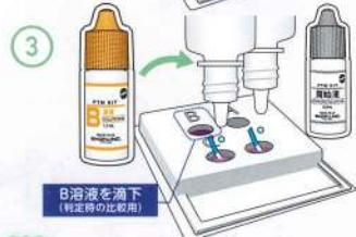
ペーパーストリップスを浸したウェルに開始液を1滴滴下します。判定時の比較用として、標準液(B溶液)を対象のウェルBに1滴滴下します。
